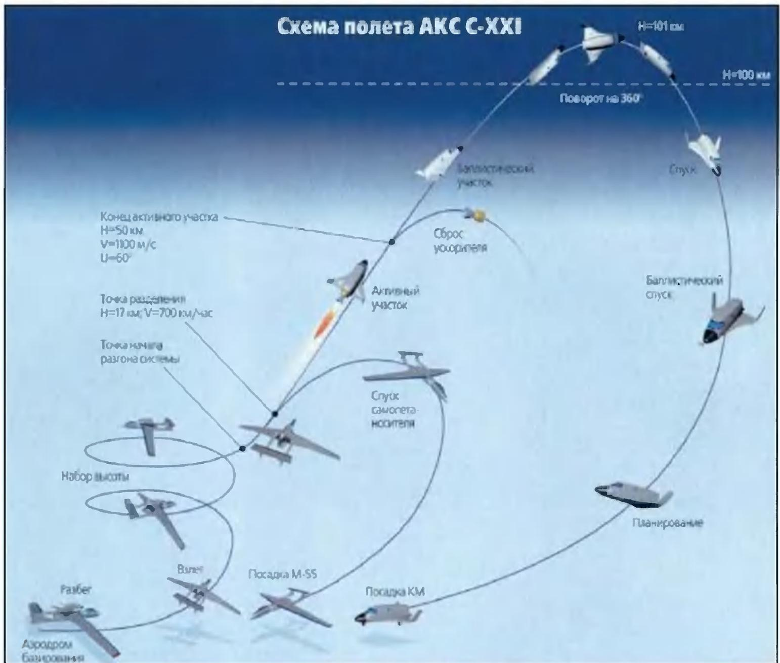
самолета и модуля. Носитель возвращается на аэродром, а модуль с включенным ускорителем начинает набор высоты. После выработки топлива ускоритель отстыковывается, и модуль С-XXI продолжает полет по баллистической траектории, достигая высоты более 100 км. А затем совершает спуск, используя аэродинамическое торможение корпусом, затем тормозные парашюты, и, наконец, производит планирующую посадку на полосу по-самолетному.
