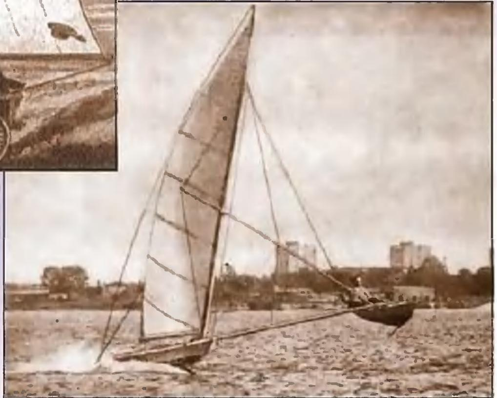
тиводействуют силы сцепления с дорогой, и, главное, на это почти не требуется тратить энергию. На воде же боковой упор создается за счет киля судна, который работает как крыло.
